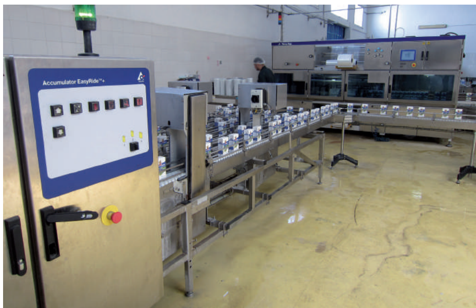
Colainord a investi dans la fabrication de lait UHT, avec des machines pouvant atteindre les 300.000 berlingots par jour (Ph. Adam)
